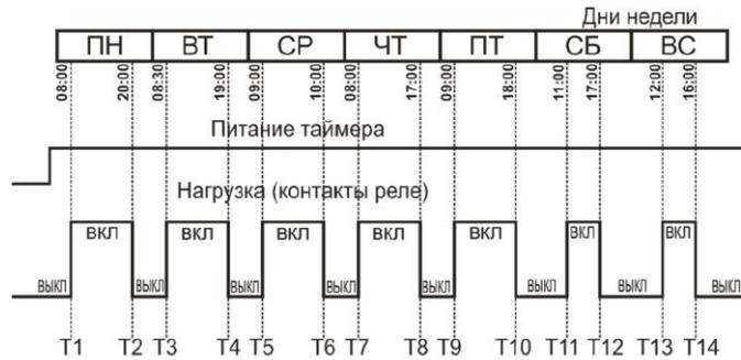
Рисунок 3.4 – Включение нагрузки на примере недельного режима работы
